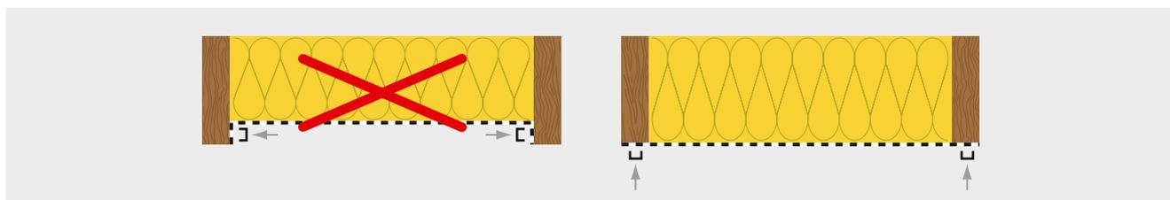
3. Voorzie een ruimte na het plaatsen van het lucht/dampscherm voor de elektriciteitsleidingen, zodat u het scherm niet hoeft te doorboren.
